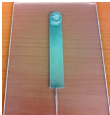
Probekörpergeometrie zur Untersuchung des hybriden Mehrkomponentenspritzgießens
